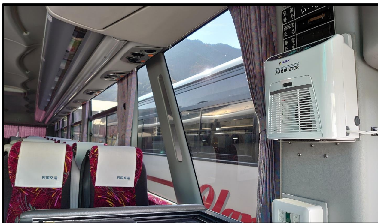
貸切バス車内出入口付近に設置したエアバスター本体
